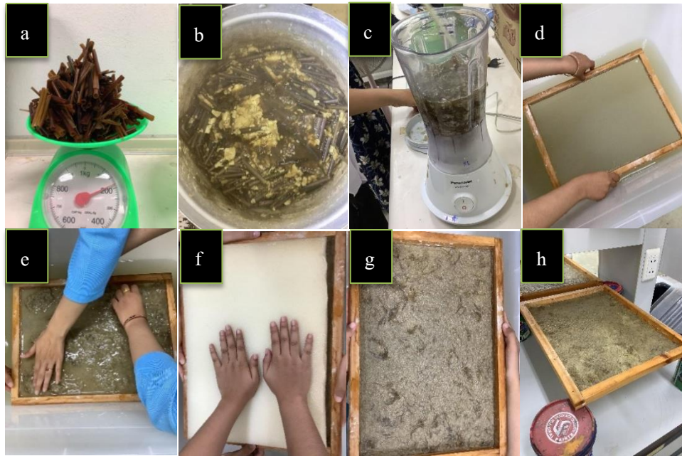
ภาพที่ 1 แสดงขั้นตอนการผลิตกระดาษ a) การชั่งเยื่อตามอัตราส่วน b) การต้มเยื่อ c) การปั่นเยื่อ d) การร่อนเยื่อ e) การเกลี่ยเยื่อ f) การรีดน้ำออก g) กระดาษที่รีดน้ำออกแล้ว และ h) นำกระดาษไปตาก
