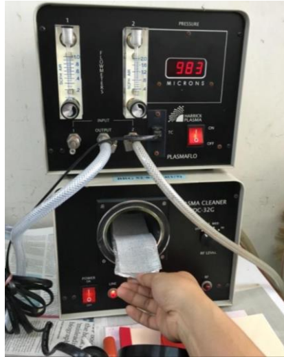
ภาพที่ 5 การนำแผ่นเส้นใยนาโนพอลิเมอร์ใส่ใน chamber เพื่อบำบัดด้วยพลาสมาของอากาศ
