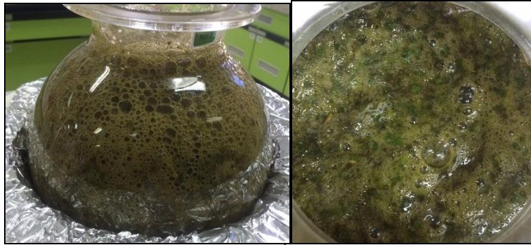
ภาพที่ 3 ลักษณะฟองจากการสกัดน้ำมันหอมระเหยจากใบหมีเหม็น
