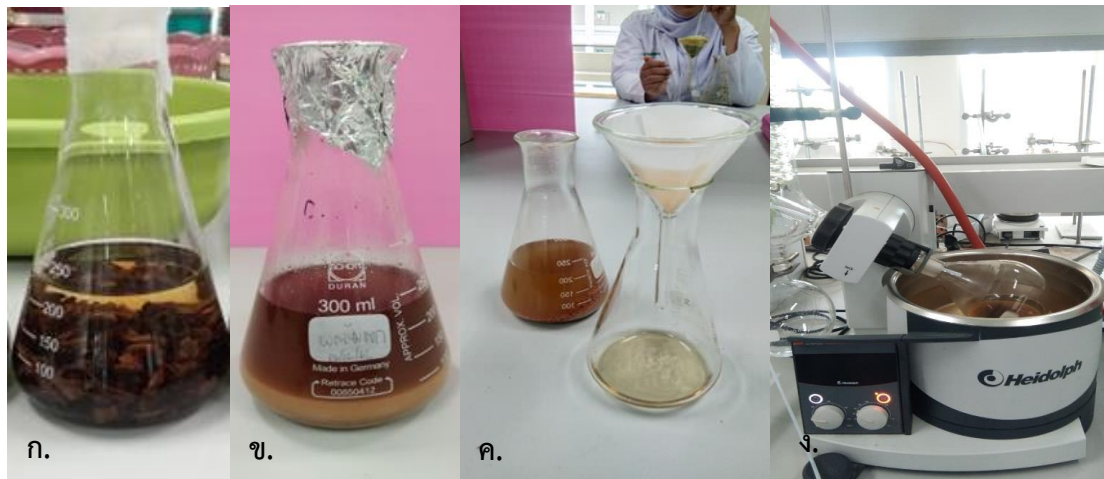
ภาพที่ 2 ขั้นตอนการสกัดส้มแขกด้วยเอทานอล ความเข้มข้น 95% โดยปริมาตร โดยวิธีการแช่ (ก.) สารสกัดที่ได้หลังจากแช่ 7 วัน (ข.) การกรองแยกกาก (ค.) และระเหยตัวทำละลายออกด้วยเครื่องกลั่นระเหยแบบหมุนภายใต้สุญญากาศ (Rotary evaporator) (ง.)
