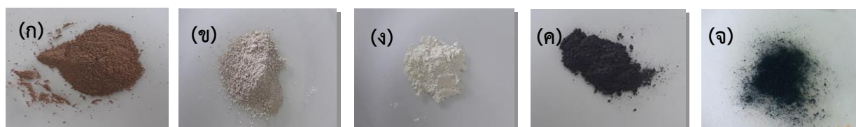
ภาพที่ 4 ผงซิงค์ออกไซด์ที่สังเคราะห์โดยใช้สารสกัดจากใบฝรั่ง (ก) ซิงค์ออกไซด์ก่อนเผา (ข) ซิงค์ออกไซด์เผาที่ 400 องศาเซลเซียส (ค) ซิงค์ออกไซด์เผาที่ 900 องศาเซลเซียส (ง) ซิลเวอร์/ซิงค์ออกไซด์เผาที่ 400 องศาเซลเซียส (จ) ซิลเวอร์/ซิงค์ออกไซด์ที่เตรียมจากซิงค์ออกไซด์เผาที่ 900 องศาเซลเซียส
