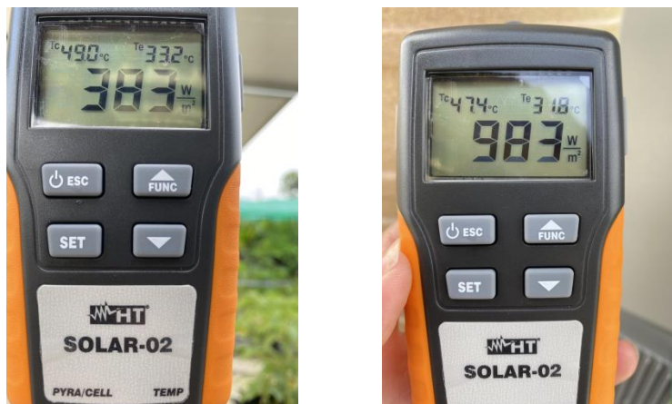
รูปที่ 5 การวัดค่าความเข้มพลังงานแสงอาทิตย์โดยใช้เครื่องวัดเพาเวอร์มิเตอร์
