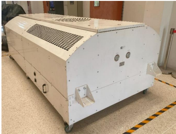
รูปที่ 1 เครื่องปรับอากาศรรางไฟฟ้าที่ใช้ทดสอบในงานวิจัย
