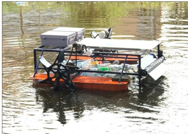
รูปที่ 14 เรือเก็บขยะพลังงานแสงอาทิตย์
