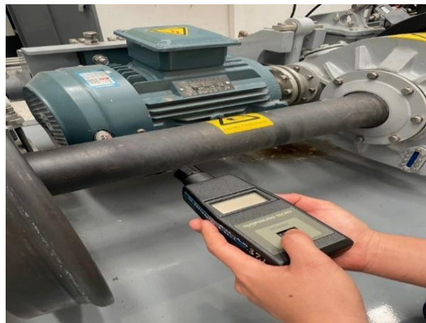
รูปที่ 3 วัดความเร็วรอบมอเตอร์ (rpm)
