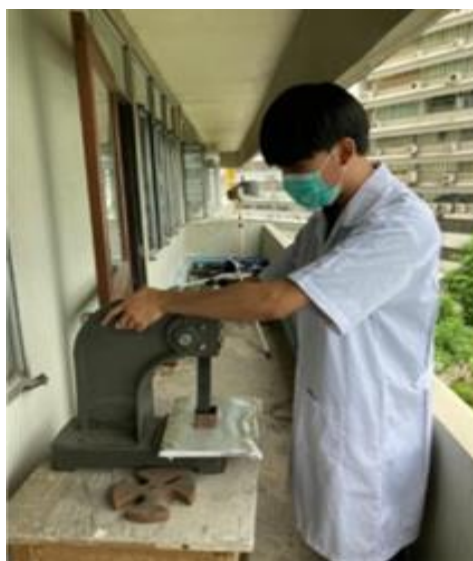
รูปที่ 2 การขึ้นรูปบล็อกปูพื้นด้วยเครื่องอัดแรงมือ
