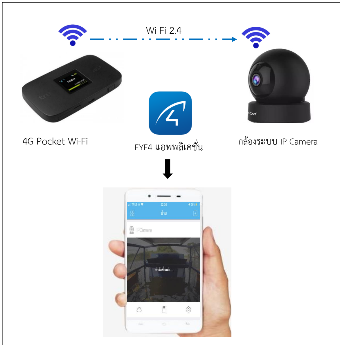
รูปที่ 8 วงจรการทำงานของระบบกล้องระบบ IP Camera
