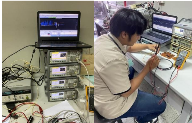
รูปที่ 4 เครื่องกำเนิดสัญญาณที่ป้อนให้วงจรการชาร์จตัวเก็บประจุยิ่งยวดที่อิสระต่อกัน
