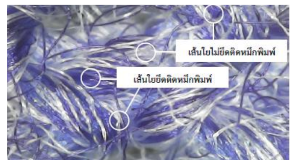
รูปที่ 6 ลักษณะการยึดติดของหมึกพิมพ์ซับลิเมชั่นบนผ้าชนิด TC [5]
