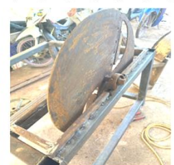
2 ติดตั้งใบมีด -นำใบมีดมาติดกับโครงสร้าง
