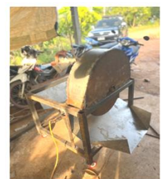
4 ประกอบฝาครอบ -นำแผ่นเหล็กตามรูปทรงมาเชื่อมค่อน และวางรองอาหาร
