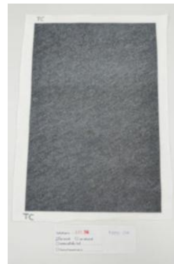
รูปที่ 4 ชิ้นตัวอย่างผ้าขนาด A4 สำหรับทดสอบความคงทนต่อการซักและการขัดถู [5]
