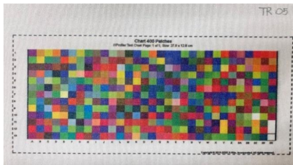
รูปที่ 2 แบบของสี ECI2002 Color Test Chart 400 Patches ที่ถ่ายโอนลงบนผ้า [5]
