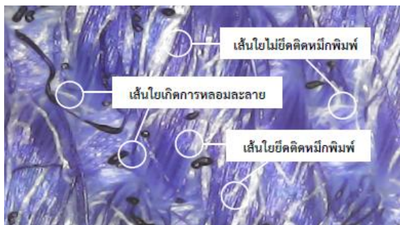
รูปที่ 7 ลักษณะการยืดยึดของหมักพิมพ์ซับลิเมชันบนผ้าชนิด TR [5]
