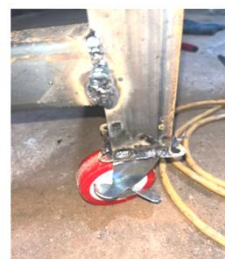
3 ติดตั้งล้อเป็นเป็น -ทำการติดตั้งล้อกับโครงสร้าง
